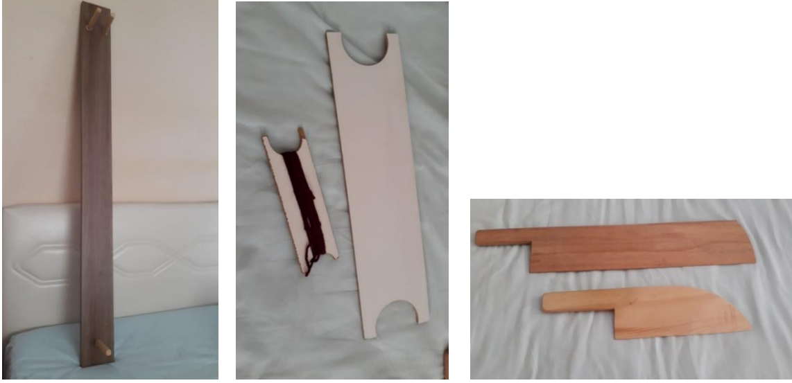
Görsel 4. Basit kolan dokuma tezgâhı ve parçaları
